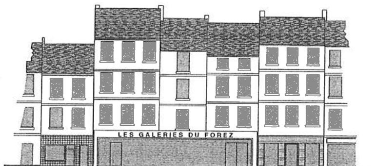
Ainsi le regroupement de plusieurs rez-de-chaussée contigus ne doit pas être un obstacle à cette perception, et ne doit pas être exprimé extérieurement, ainsi aucun bandeau continu, aucune vitrine d'un seul tenant ne doivent réunir plusieurs rez-de-chaussée. La continuité du commerce peut simplement être marquée par l'unité de style donnée à chacune des devantures appartenant à chaque immeuble différent. Il vaut mieux présenter plusieurs petites devantures qu'une seule trop longue.
